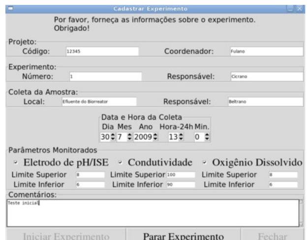
Fig. 6. Tela de cadastramento de experimentos do programa de aquisição de dados para o potenciômetro multiparâmetros.
